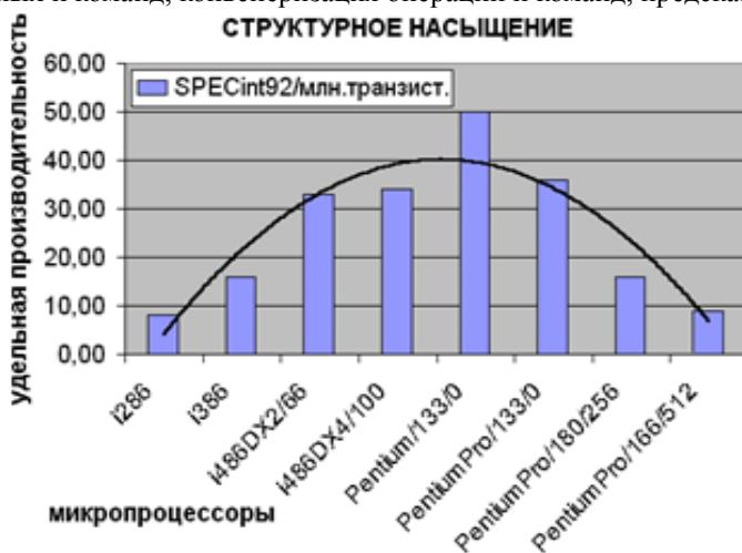
Рис.1. Структурное насыщение микропроцессорных архитектур
