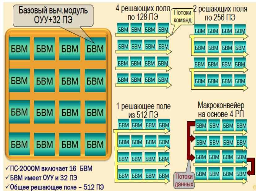
Рис.3. Multi-SIMD комплексирование БВМ внутри кристалла
