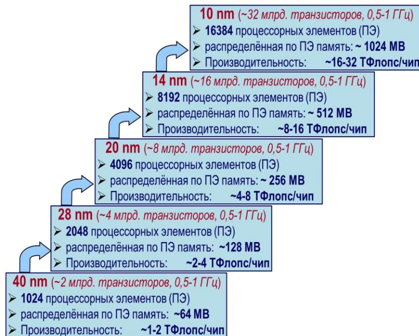
Рис. 2. Пропорциональное наращивание вычислительных возможностей однокристальных реализаций высокопараллельной архитектуры ПС-2000M по мере развития промышленных СБИС-технологий
