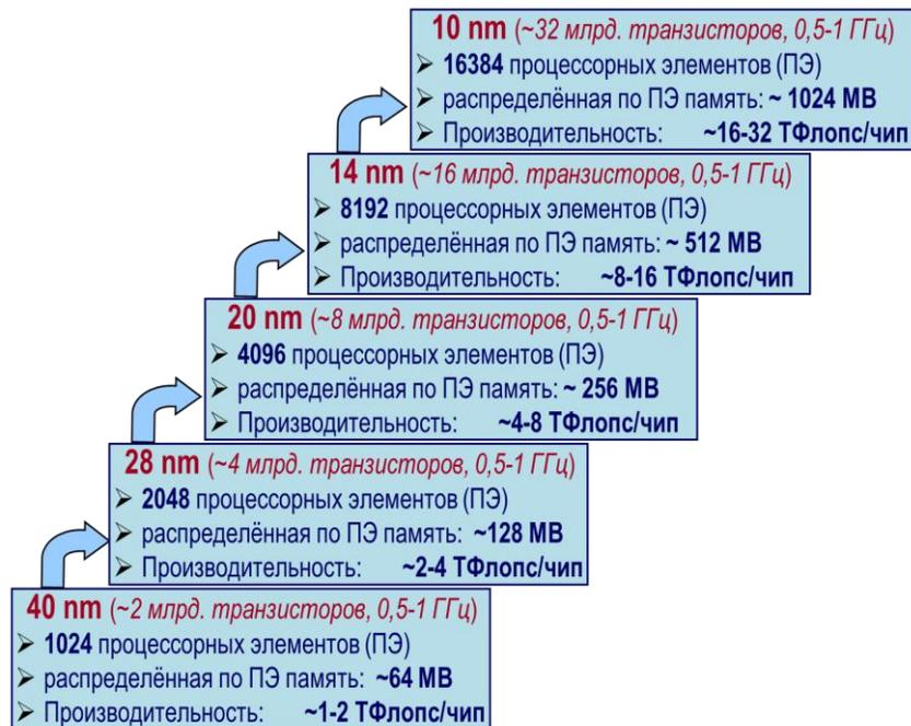
Рис. 2. Пропорциональное наращивание вычислительных возможностей однокристалльных реализаций высокопараллельной архитектуры ПС-2000М по мере развития промышленных СБИС-технологий
